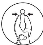
3. Faites glisser chaque collier de serrage à environ 1/8" de l'extrémité du tuyau afin de le fixer au raccord cannelé.
